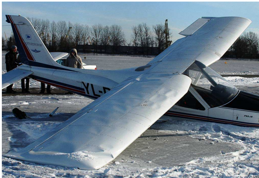
Attēls 4. Gaisa kuģa YL-ROS konstrukcijas bojājumu kopskats
