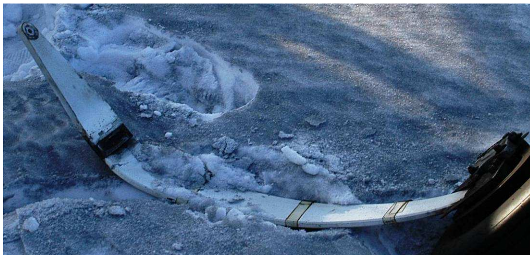
Attēls 6. Gaisa kuģa labās puses šasija ar balstu
