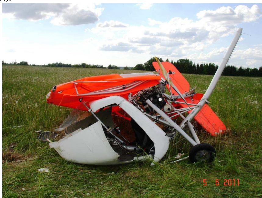
Attēls 7. Gaisa kuģa konstrukcijas bojājumi.
