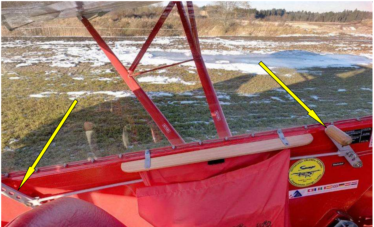
Attēls 36b. Izslēgta dzinēja gāzes rokturu pozīcija pēc gaisa kuģa ražotāja aprakstiem ( http://www.zlinaero.com/images/savage/aero2010/cockpit.html )
