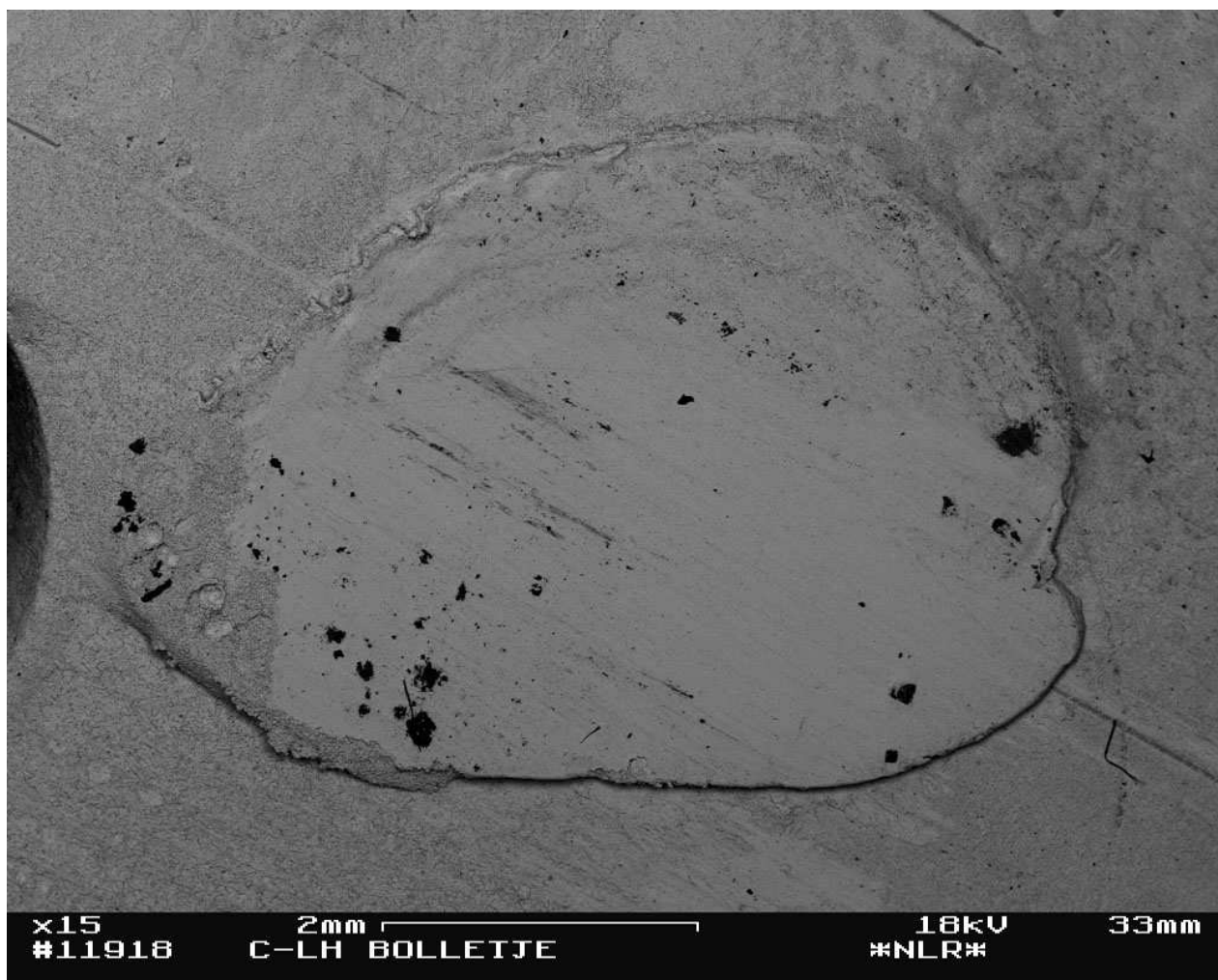
Attēls A.1: Skats no augšas uz kloķvārpstas ieliktna virsmas vietu no kuras noņemts piesārņojuma materiāls
