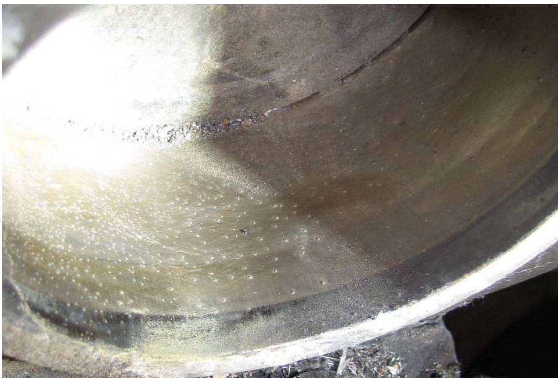
Attēls 20. Piles uz 3.cilindra sienas
