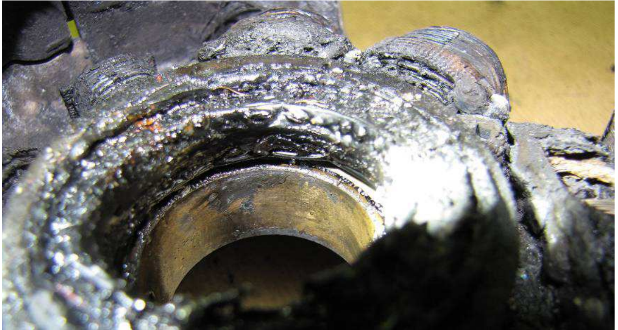
Attēls 30. Metāla notraipījums uz aizmugures kloķvārpstas gultņa
