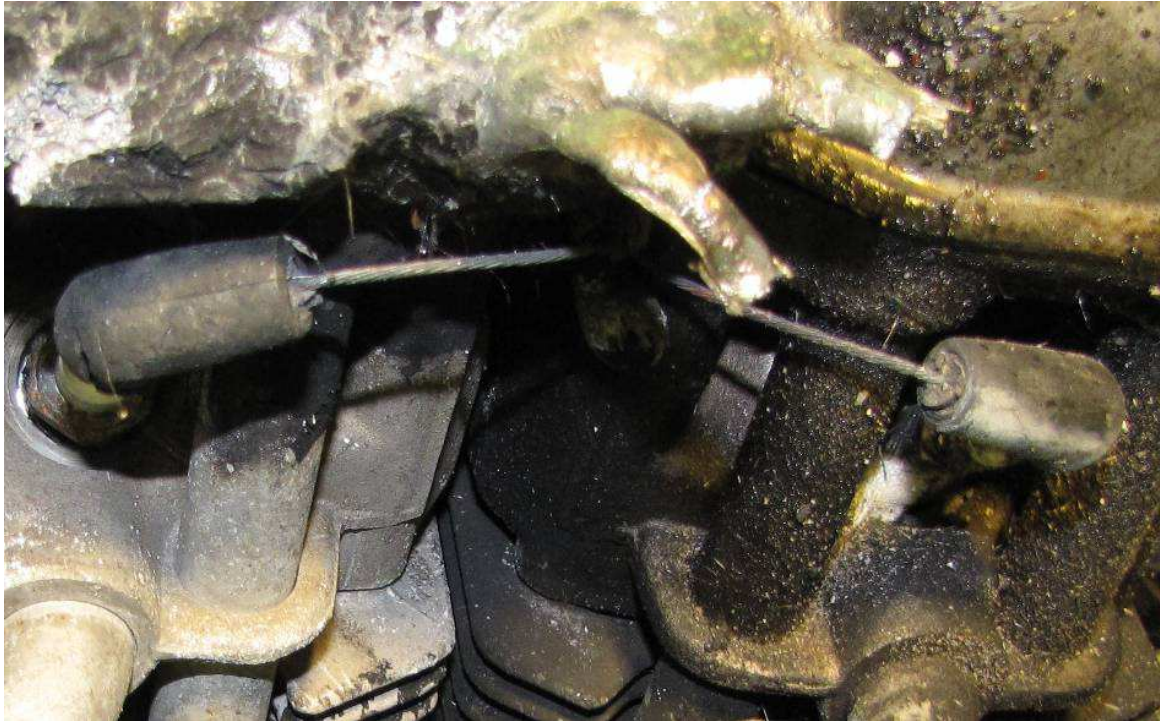
Attēls 15. Daļēji apdedzināti aizdedzes sveču savienojumi
