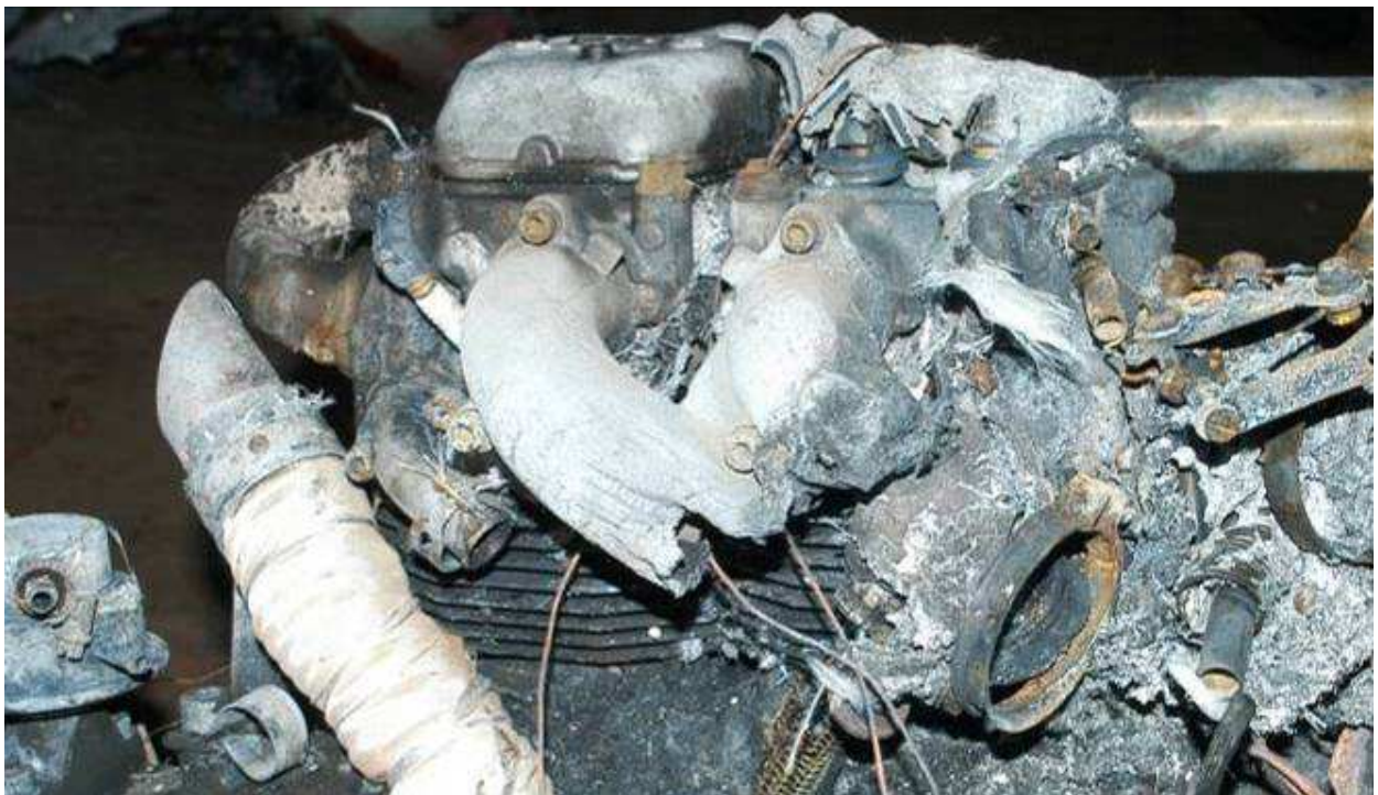
Attēls 9. Gāzes izplūdes kolektors
