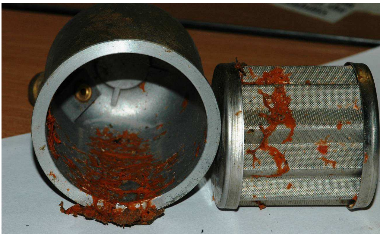
Attēls 8. Degvielas nogulsnešanās metāliskā apvalkā un filtra piesārņojums
