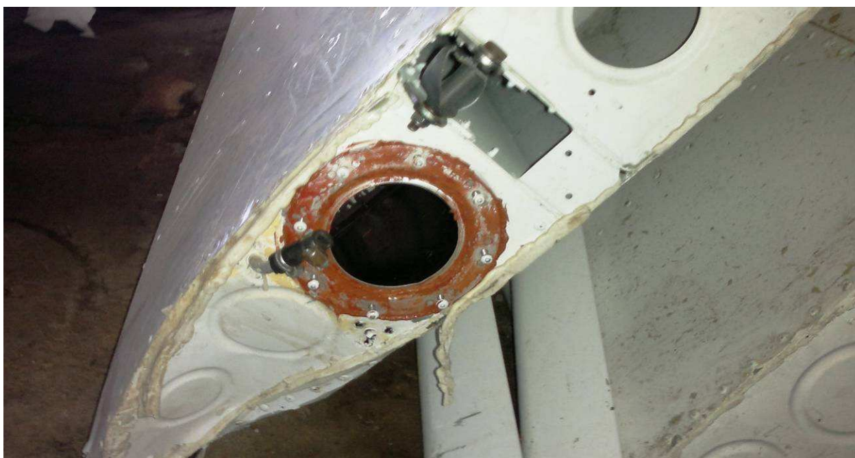
Attēls 11. Degvielas līmeņa mērītāja hermetizācijas materiāla paliekas
