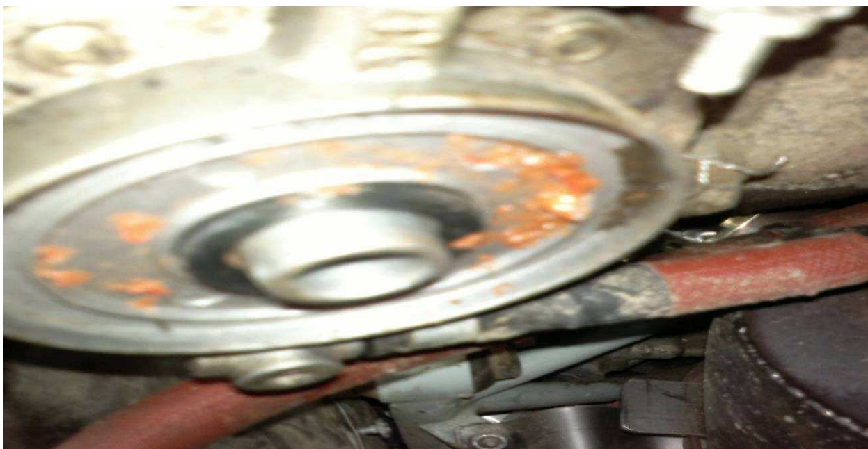
Attēls 9. Degvielas nogulsnešanās metāliskā apvalka pievienošanas vieta
