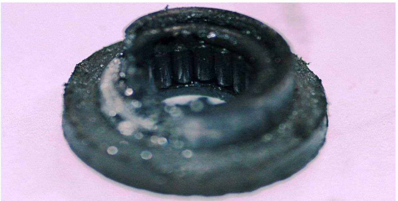
Att. 14. Adatu gultņa separatoru sairšana
