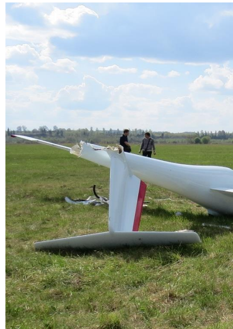
Attēls 4. Gaisa kuģa augstuma un virziena stabilizatori
