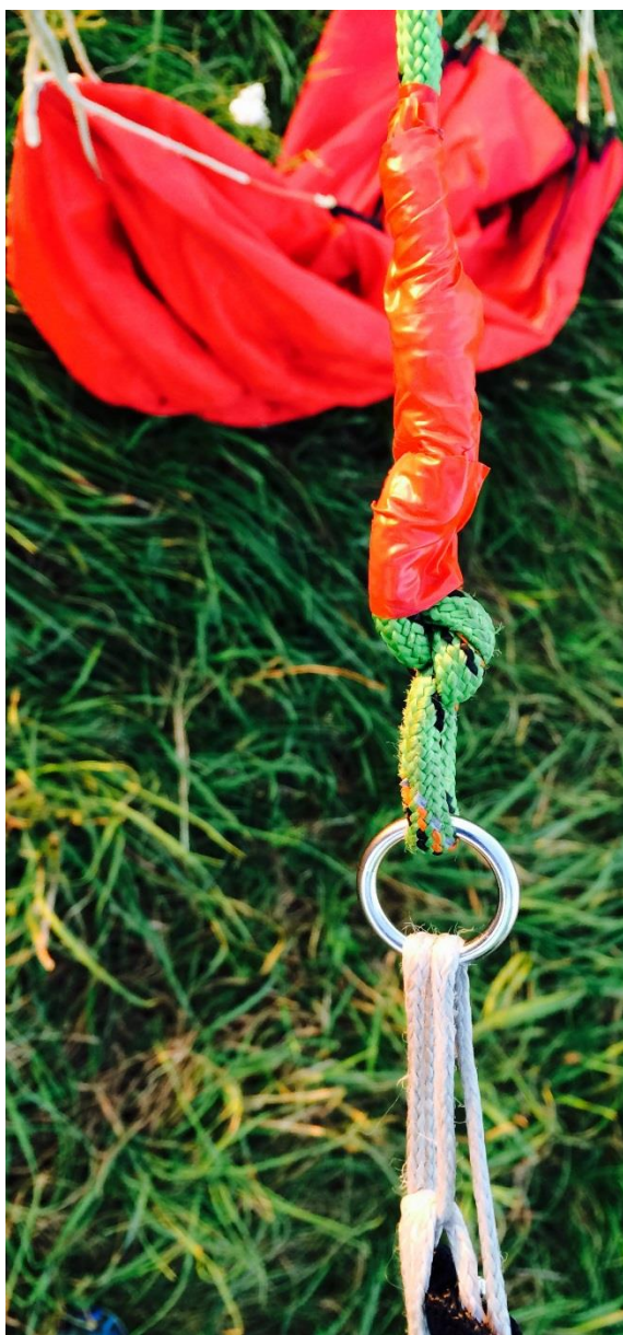
Attēls 5. Planiera sakabes mehānisms
