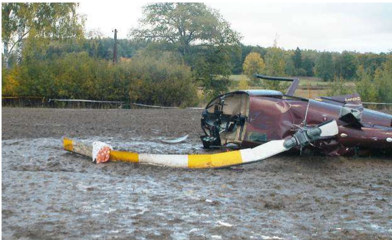
Attēls 15. Galvenā rotora stāvoklis pēc sadursmes ar zemi
