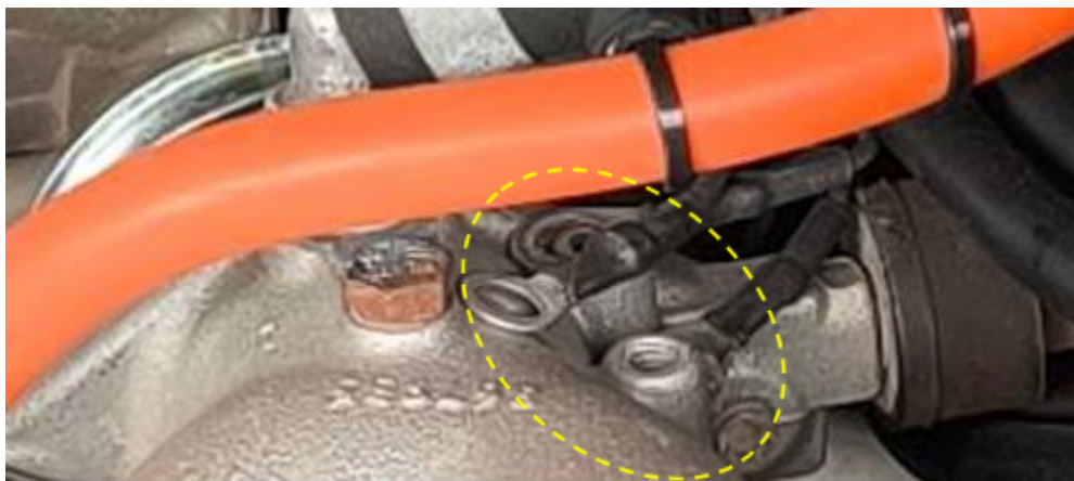
Att. 12. Zemējuma vadu novietojums uz kolektora
