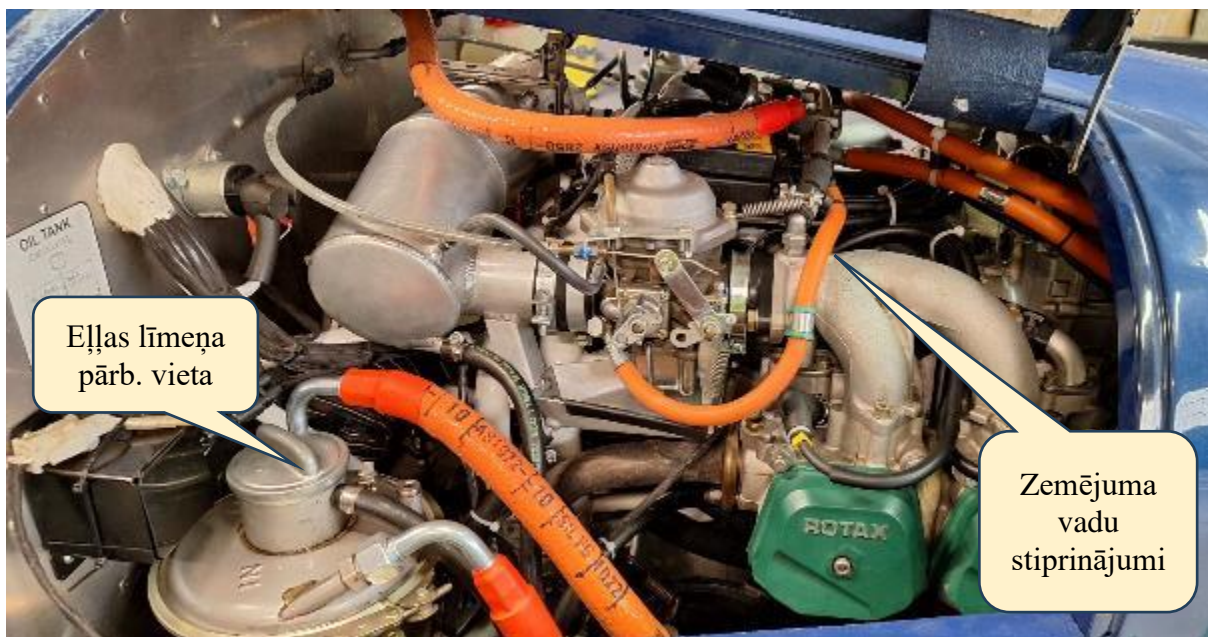
Att. 16. Gaisa kuģa Tecnam P2008 JC skats pēc labo pārsega durvju atvēršanas
