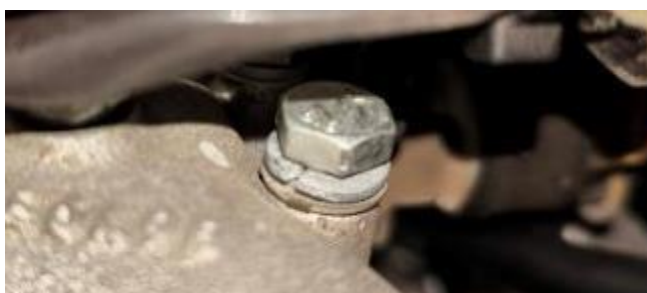
Att. 15b. Dzinēja zemējuma vadu stiprinājums pie ielūdes kolektora ar sešstūrgalvas skrūvi M6x16 un sprostpaplāksni A6 (paraugs no gaisa kuģa Tecnam P2008 JC, r/n YL-EVE)
