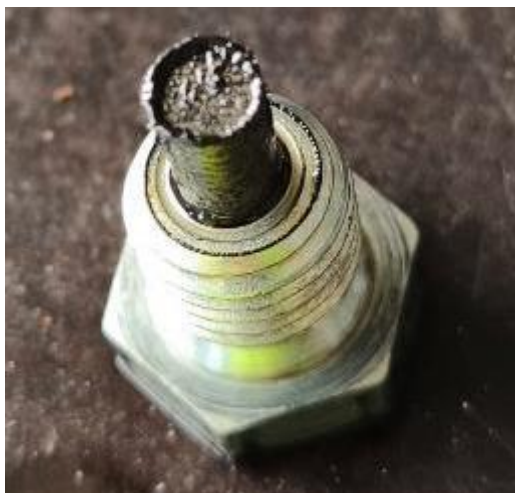
Att. 7. Dzinēja eļļas sistēmas magnētiskais devējs
