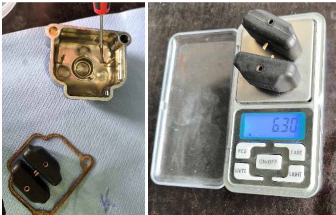
Att. 9. Gaisa kuģa kreisā karburatora pludiņu kamera ar pludiņiem
