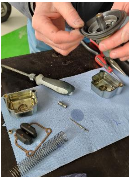
Att. 10. Gaisa kuģa karburatora iekšējo komponentu pārbaude
