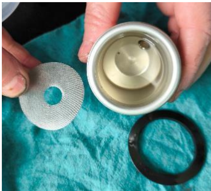
Att. 8. Gaisa kuģa degvielas sistēmas rupjais degvielas filtrs (Gascolator)
