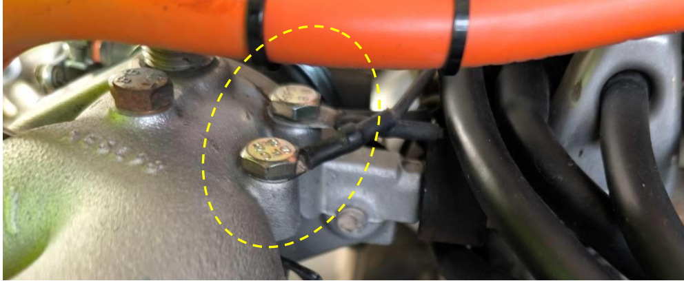
Att. 13. Ar sešstūrīgalvas skrūvēm piestiprinātie zemējuma vadi uz labā ieplūdes kolektora
