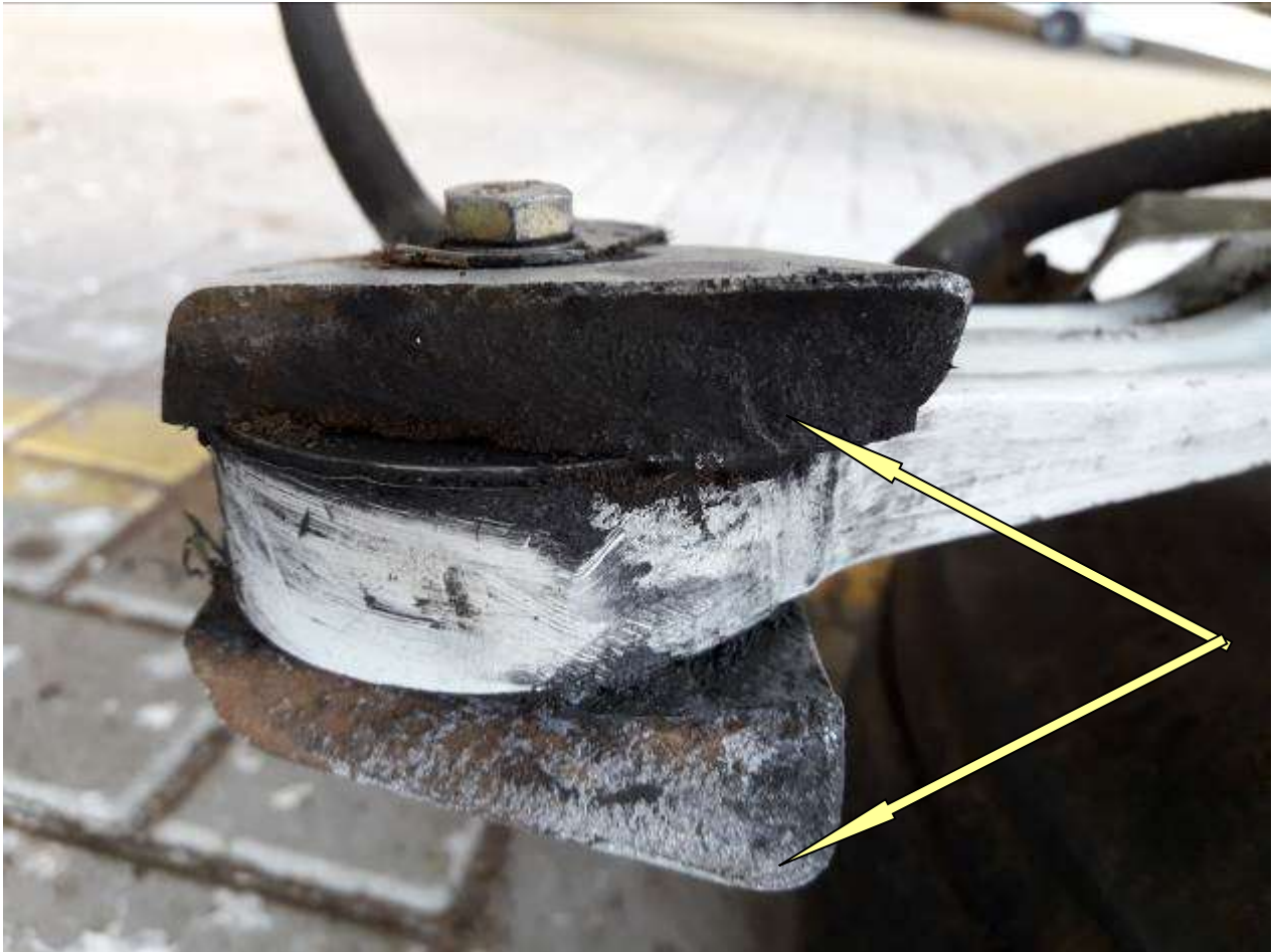
Att. 5. Nolaucītie stiprinājumu atloki (auss)
