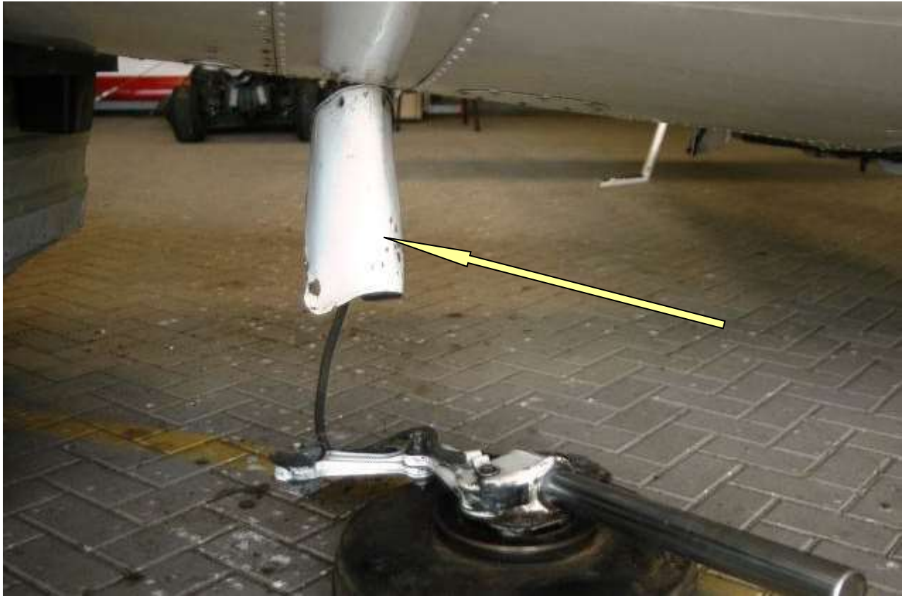
Att. 3. Labās šasijas balsta cilindra vairogs
