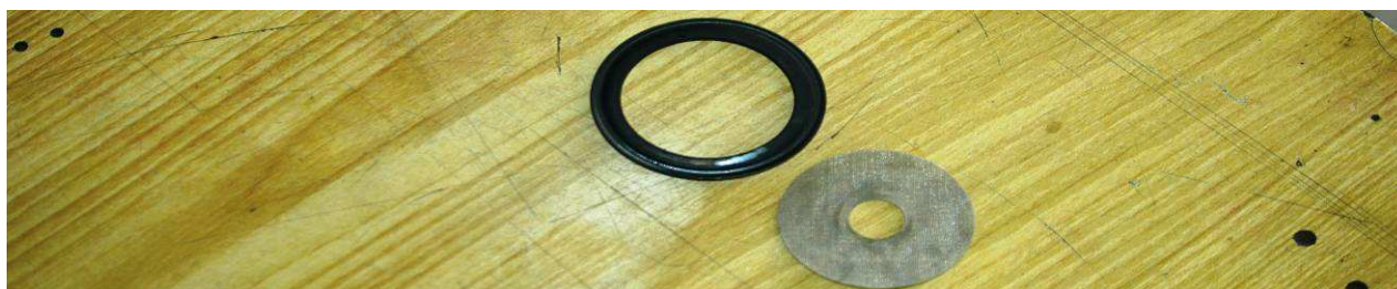
Att. 8. Degvielas nogulsņēšanas korpusa blīve un filtrs
