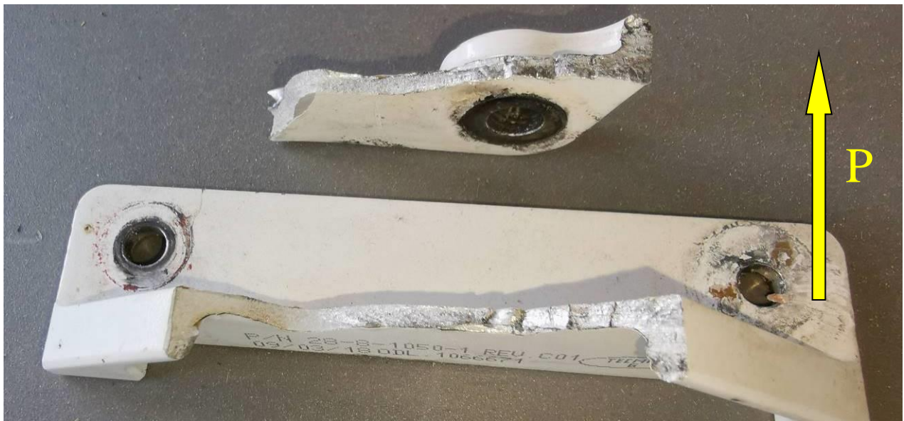
Att. 11. Abas kreisās puses atloka salūzušās daļas un spēka P darbības virziens
