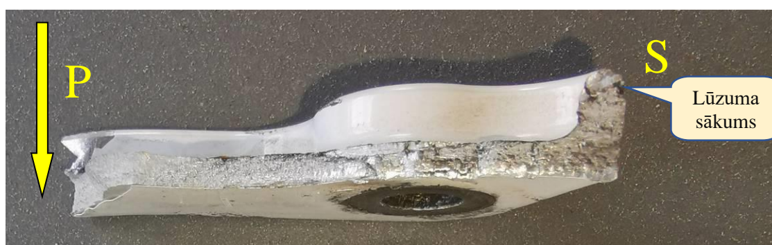
Att. 14. Atlūzušās daļas lūzuma virsmas attēls
