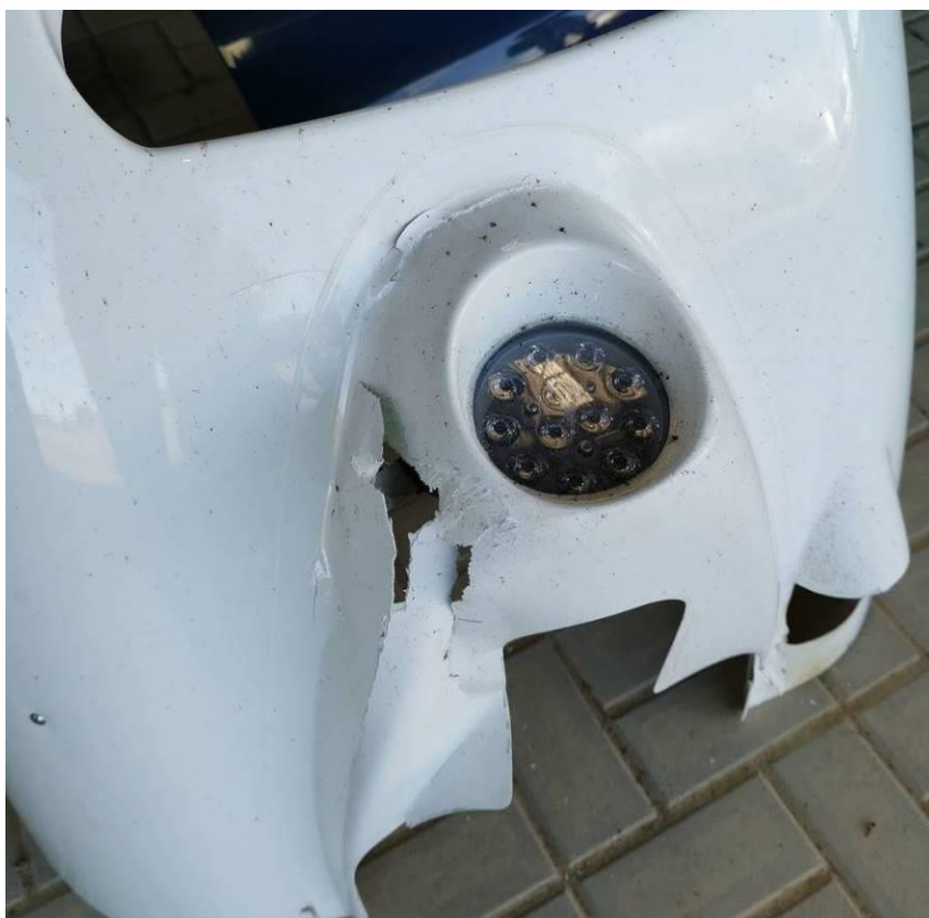
Att. 6. Gaisa kuģa fizelāžas apakšējās daļas bojājumi
