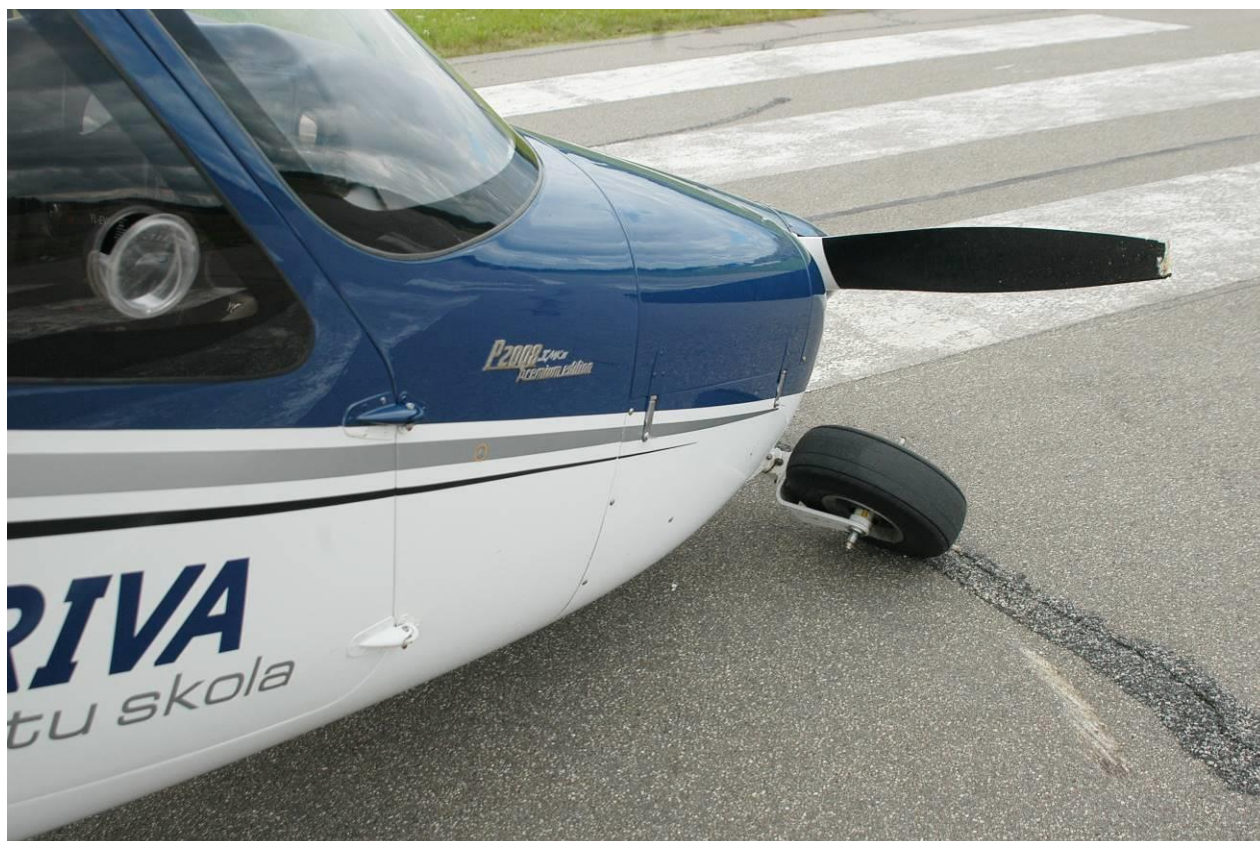
Att. 2. Priekšējās šasijas bojājums
