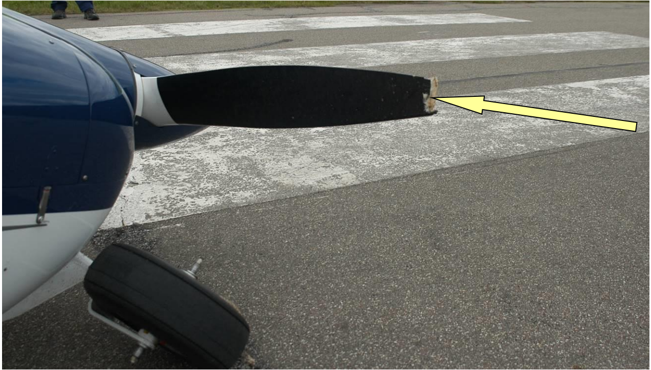
Att. 3. Propellera bojājums
