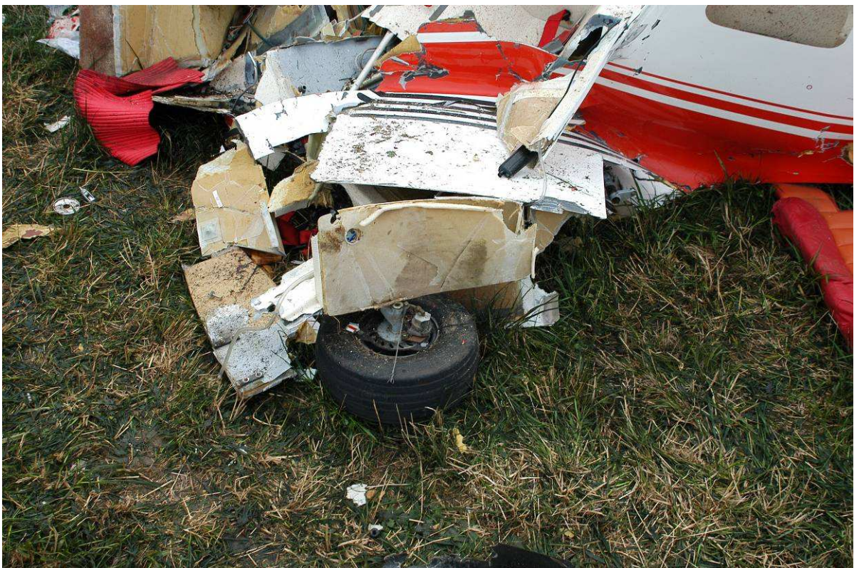
Attēls 17, Šasijas kreisās puses nolauztais balsts
