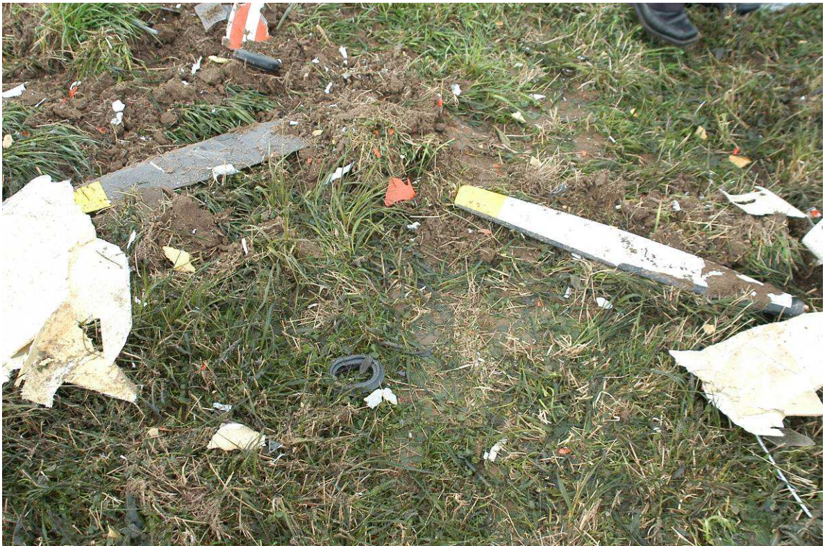
Attēls 14, Propellera sadursmes ar zemi vieta
