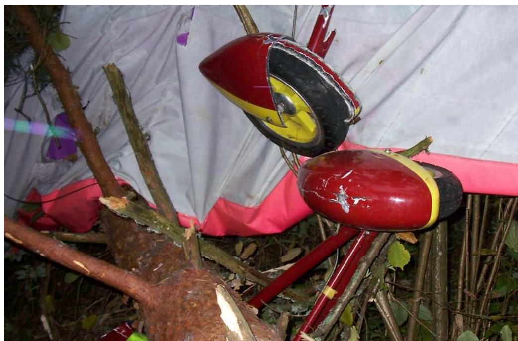
Attēli 2. un 3. Motodeltaplāna Kvant 03S konstrukcijas bojājumi
