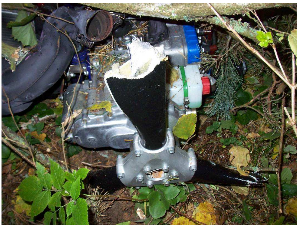
Attēls 8. Propellera stāvoklis pēc sadursmes ar koku
