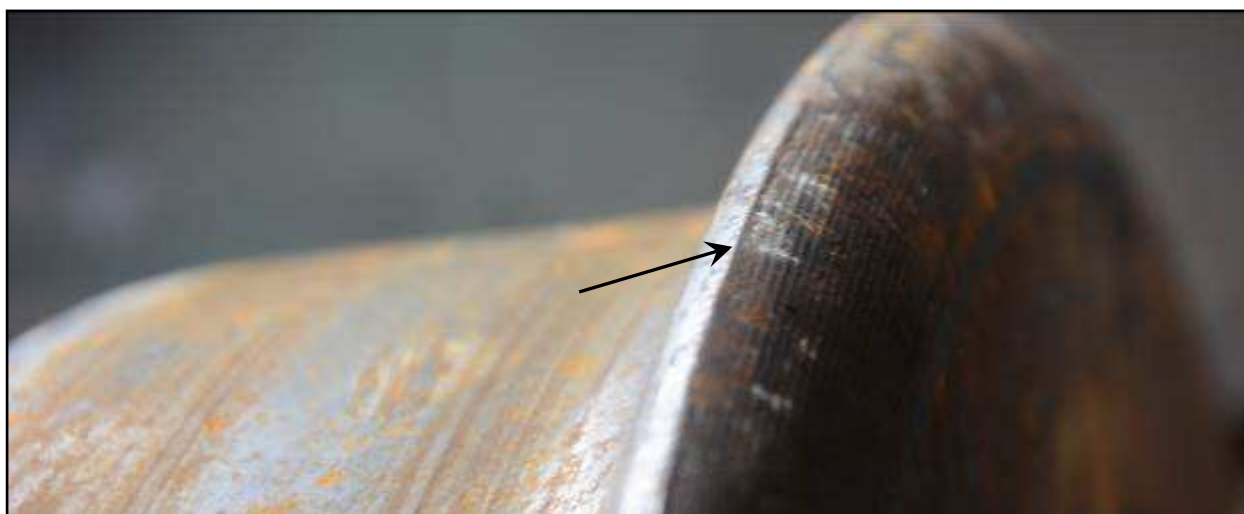
6.12. att. Asšķautņainais uzvelmējums uzmalas virsotnē
