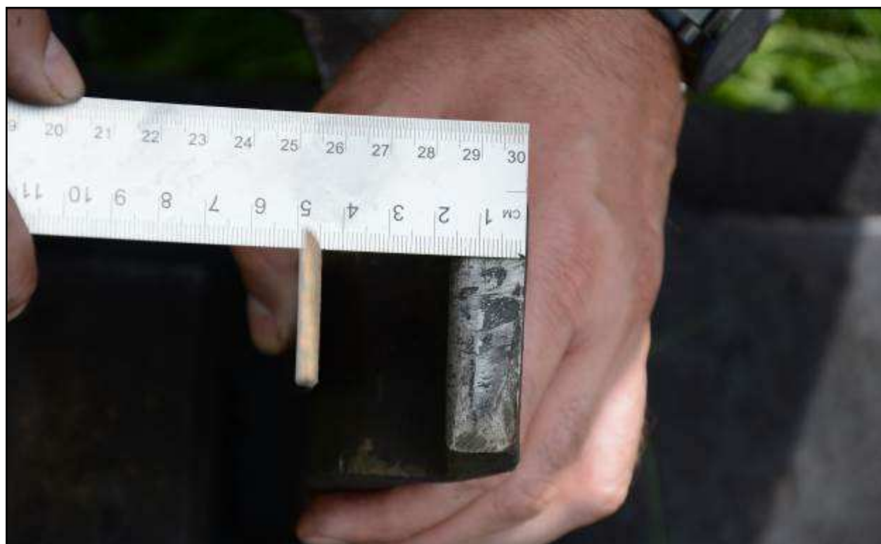
6.10.att. Labā aizliktņa augstuma noteikšana
