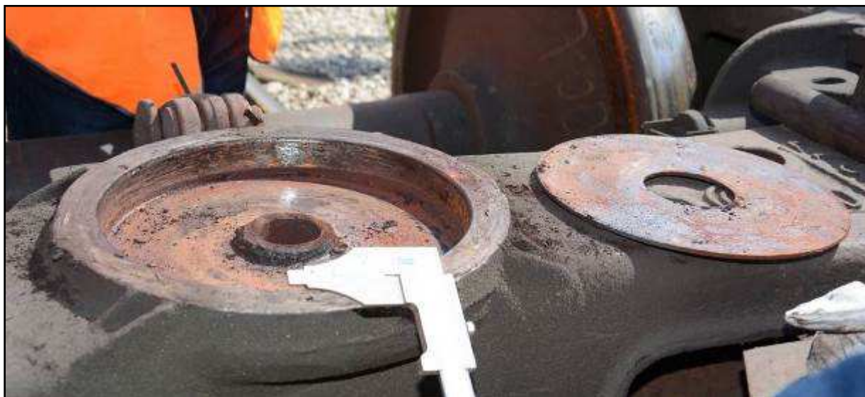
6.17. att. Cisternas Nr. 56904519 aizmugurējo ratiņu virsatsperu sijas balstpēda
