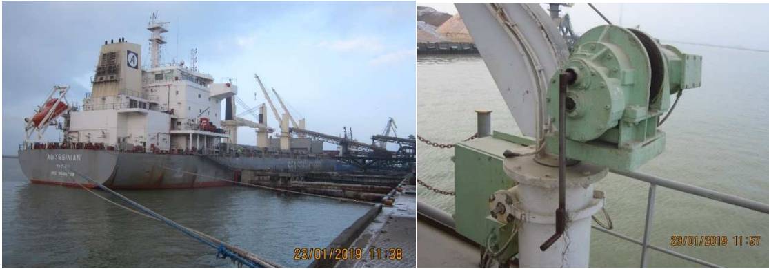
7.3. att. Kuģis ABISSYNIAN Liepājas ostā un kuģa ceļamkrāna rokturis, kura brīv kustības rezultātā apkalpes loceklis tika smagi ievainots darbu laikā (22.01.19. negadījums)
